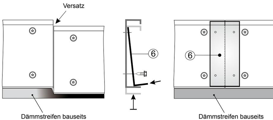
Stützwinkel Pos.6 bei werkseitig angebautem Grundrahmen wenn bei den Kubenstößen unterschiedliche Gewichte zu einem Versatz führen (Montage bauseits)
