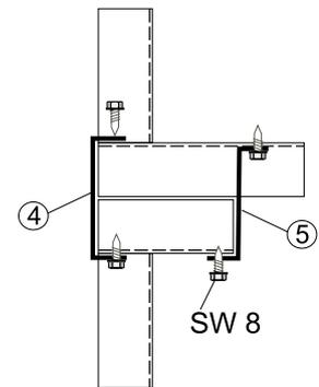
**Achtung:** Waagerechte und vollständige Auflage für alle Grundrahmen - Längsprofile erforderlich (Kontrolle durch Richtlatte).
