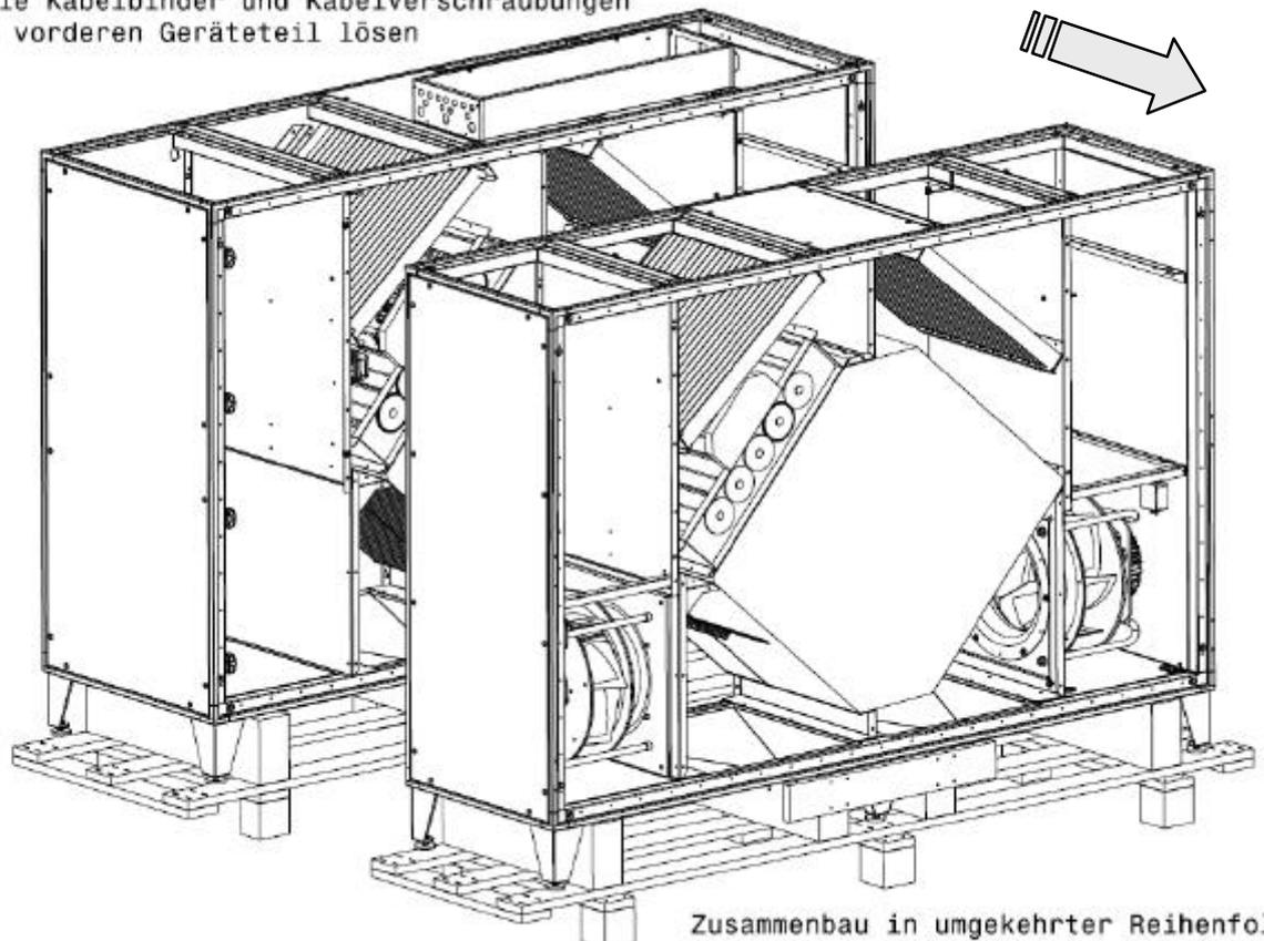
Zusammenbau in umgekehrter Reihenfolge
