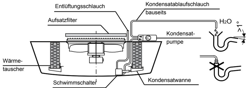
Kondensatpumpe (Pos.1) mit den beiliegenden Schrauben  $\varnothing 4,2 \times 9,5$  (3x Pos. 3) an der Halterung (Pos.2) befestigen. Halterung mit montierter Kondensatpumpe auf dem Gerät mit den beiliegenden Schrauben  $\varnothing 4,8 \times 38$  (2x Pos.4) befestigen (Skizze oben).
