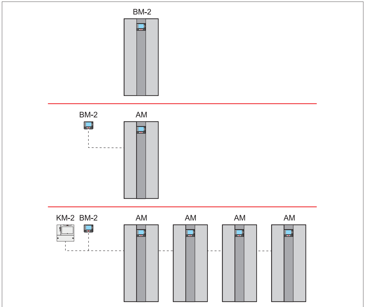
Abb. 5.26 Mögliche Steckplätze für Regelungsmodule
