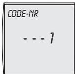
Der richtige Code wird durch Drücken (Anzeige blinkt im Display) und anschließendes Drehen des rechten Drehknopfs, von 0 auf 1, eingestellt. Nachdem der Code von 0 auf 1 verändert ist, wird durch erneutes Drücken des rechten Drehknopfs die Einstellung bestätigt und man befindet sich in der Fachmannebene. In der Fachmannebene können Sie anlagenspezifische Parameter einstellen oder abfragen.
