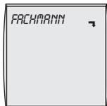
Rechten Drehknopf drücken, um in die 2. Bedienebene zu wechseln. Durch Drehen des rechten Drehknopfs im Uhrzeigersinn die Menüebene „Fachmann“ anwählen und durch erneutes Drücken des rechten Drehknopfs die Auswahl bestätigen. Im Display erscheint die Codeabfrage.
