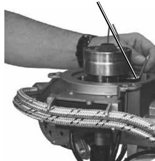
5.3.5 Zündkabel von Zündelectroden abziehen und Mischkopf ablegen.
