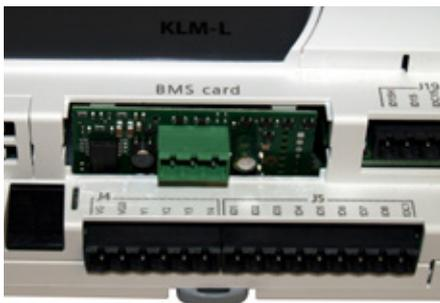
4. Modbus-Schnittstelle im freien Steckplatz so einstecken, dass eine Steckverbindung zwischen dem Verbindungsblock der Modbus-Schnittstelle und den Pins des Klima- und Lüftungsmoduls hergestellt wird (Verbindungsblock rastet ein).
