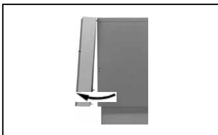
Bild: Demontage Frontverkleidung
