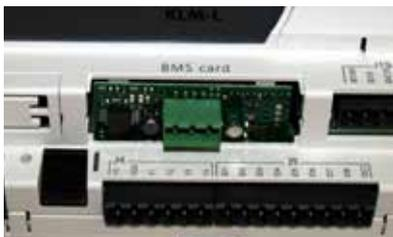
4. Modbus-Schnittstelle im freien Steckplatz so einstecken, dass eine Steckverbindung zwischen dem Verbindungsblock der Modbus-Schnittstelle und den Pins des Klima- und Lüftungsmoduls hergestellt wird (Verbindungsblock rastet ein).
