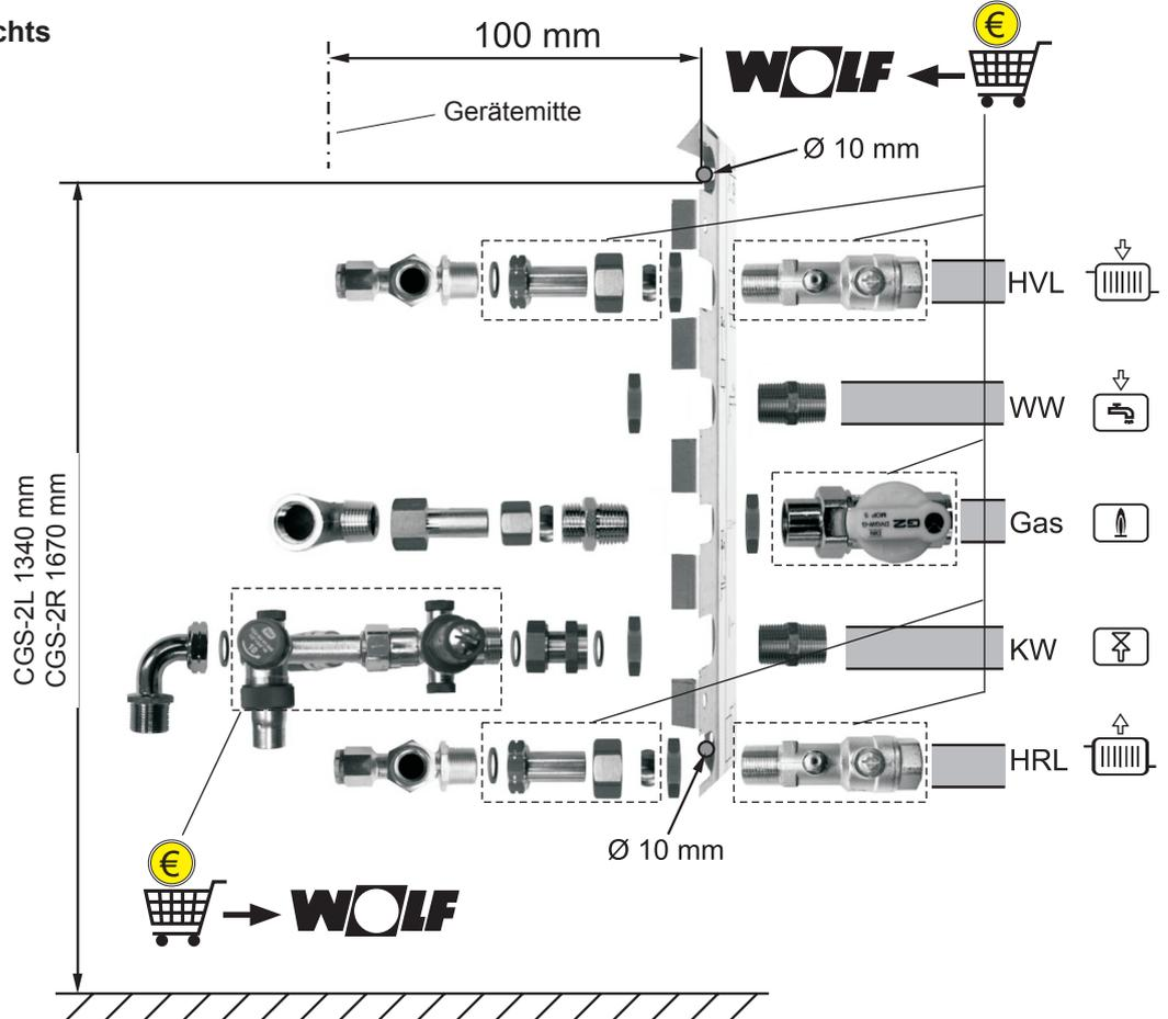
Edelstahlschläuche ggf. kürzen und mit Flachdichtungen montieren.
