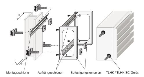
Gesamte Einheit (TLHK / TLHK-EC-Gerät, Befestigungskonsolen und Aufhängeschienen) in Montageschiene einhängen. Um den TLHK / TLHK-EC vor Anschluss der Rohrleitungen gegen Aushängen zu sichern, untere Aufhängeschiene mit mitgeliefertem Befestigungszubehör am Stahlträger arretieren.
