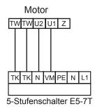
TLHK-Einphasen- und Drehstrommotoren sind mit Thermokontakten ausgerüstet. Diese unterbrechen bei Überhitzung des Ventilator-Motors den Steuerstromkreis im Stufenschalter oder Steuergerät.
