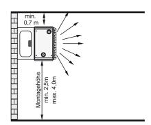
Für eine gleichmäßige Temperaturverteilung im Raum ist es zweckmäßig, statt eines größeren Gerätes mehrere kleinere Geräte zu installieren. Dabei sollte die Anordnung nach Möglichkeit so getroffen werden, dass die Geräte nicht gegeneinander blasen, sondern sich in der Luftumwälzung unterstützen. Freier Umluftansaug muss stets gewährleistet sein.
