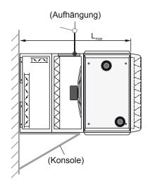
Befestigungsschrauben Ø 8 mm in Wand setzen.
