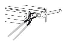
Beim Anschließen der Wärmetauscher mit einer Rohrzange gegenhalten.
