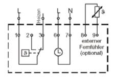
In Kunststoffgehäuse 132 x 82 x 32 mm für Stecksockelmontage, Tag- bzw. Nachttemperatur getrennt einstellbar.
