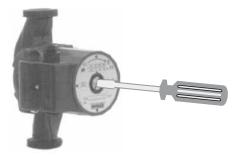
Vor Inbetriebnahme und nach längerem Stillstand ist die Pumpe zu entlüften. Dies darf nur im Stillstand erfolgen. Hierzu wird der Stopfen gemäß Bild gelöst. Wenn Wasser austritt wird der Stopfen wieder angezogen.
