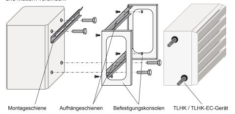
Gesamte Einheit (TLHK / TLHK-EC-Gerät, Befestigungskonsolen und Aufhängeschienen) in Montageschiene einhängen. Um den TLHK / TLHK-EC vor Anschluss der Rohrleitungen gegen Aushängen zu sichern, kann die untere Aufhängeschiene mit Schraube und Dübel fixiert werden.
