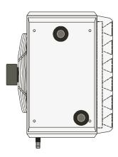
In periodischen Zeitabständen Kondensatwanne und Ablaufstutzen überprüfen und ggf. reinigen.
