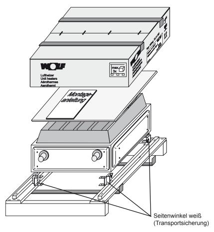
Die vier Seitenwinkel (Transportsicherungen) entfernen. Sie dürfen nicht als Gerätebefestigung für Wand oder Decke verwendet werden!
