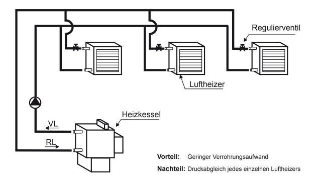
Beispiel 2: Rohrführung nach Tichelmann (Gleichlange Leitungsstränge je Luftheizer ersetzen den individuellen Abgleich)
