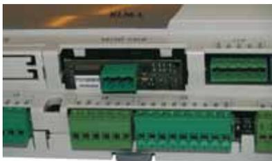
4. LON-Schnittstelle im freien Steckplatz so einstecken, dass eine Steckverbindung zwischen dem Verbindungsblock der LON-Schnittstelle und den Pins des Klima- und Lüftungsmoduls hergestellt wird (Verbindungsblock rastet ein).
