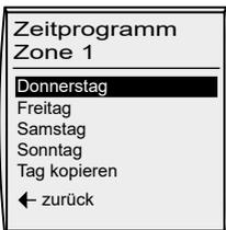
Durch weiteres drehen des rechten Drehknopfs „Kopieren Tag“ anwählen, und durch erneutes drücken die Auswahl bestätigen. Es wird automatisch in den Kopierbereich gewechselt.
