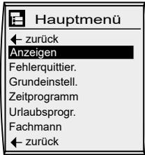
Durch **Drücken des rechten Drehknopfs** gelangt man in die zweite Bedienebene, in der man durch drehen des rechten Drehknopfs im Uhrzeigersinn die in der Übersicht dargestellten Menüebenen auswählen kann. Nach Auswählen des Parameters gelangt man durch nochmaliges Drücken mit dem rechten Drehknopf in das Untermenü.
