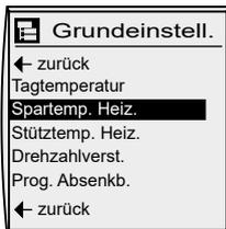
Spartemperatur mit rechtem Drehknopf auswählen und bestätigen. Durch Drehen des rechten Drehknopfes gewünschte Spartemperatur einstellen und anschließend bestätigen.
