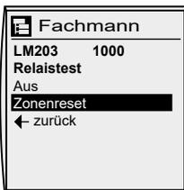
Unter Zonenreset können alle Parameter die in einen Modul abgespeichert sind auf Werkseinstellung gesetzt werden.
