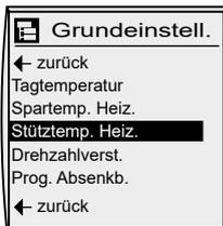
Stütztemperatur Heizen mit rechten Drehknopf auswählen und bestätigen. Durch Drehen des rechten Drehknopfes gewünschte Stütztemperatur Heizen einstellen und anschließend bestätigen (siehe Standardfunktionen - Stützbetrieb Heizen).
