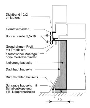
Gerät mit den mitgelieferten Tropfleisten 60 x 2 und dem Verbindungsmaterial mit dem Grundrahmen verbinden.
