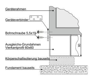
Gerät mit den mitgelieferten Geräteverbindern und dem Verbindungsmaterial mit dem Grundrahmen verbinden.
