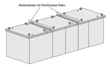
Die Dächer der wetterfesten Geräte können zur Montage betreten werden. Hierbei ist auf eine Flächenverteilung der Last (Bretter) zu achten. Auf die Dächer darf keine statische Punktlast ausgeübt werden.
