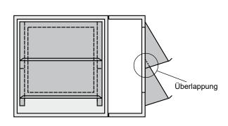
Seitenteile und Oberteil mit mitgelieferten Schrauben gemäß Darstellung montieren.
