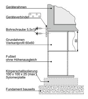
Gerät mit den mitgelieferten Geräteverbindern und dem Verbindungsmaterial mit dem Grundrahmen verbinden.
