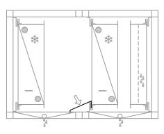
Die Wannenüberbrückung ist werksseitig bereits eingebaut, wenn die Funktionsbauteile als eine Transporteinheit geliefert werden.
