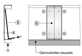
Stützwinkel Pos. 6 (siehe auch eigene Anleitung) bei werksseitig angebautem Grundrahmen wenn bei den Kubenstößen unterschiedliche Gewichte zu einem Versatz führen (Montage bauseits)
