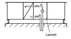
Die Wärmetauscher (Kühler, Erhitzer) arbeiten im Gegenstromprinzip, d.h. das Wärmebzw. Kälteträgermedium wird entgegen der Luftrichtung geführt. Der jeweilige Vorlaufanschluss befindet sich daher immer auf der Luftaustrittseite des Wärmetauschers.
