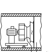
Beim freilaufendem Ventilatorrad darf die am Ventilatortypenschild angegebene maximale Drehzahl auch beim Betrieb mit einem Frequenzumformer nicht überschritten werden. Die angegebene Motorstromaufnahme darf nicht überschritten werden.
