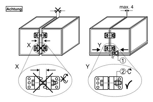
Der Zusammenbau der Kubenbauteile kann durch das Verwenden von Zurrgurten erleichtert werden. Geräteteile aneinanderstellen und mit Zurrgurten zusammenziehen. Anschließend die Komponenten über die beiliegenden Geräteverbinder miteinander verschrauben.
