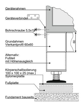
Gerät mit den mitgelieferten Geräteverbindern und dem Verbindungsmaterial mit dem Grundrahmen verbinden.
