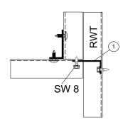
Verbindungswinkel Pos. 1 (siehe auch eigene Anleitung) bei Anbindung an z.B. RWT (Montage bauseits)
