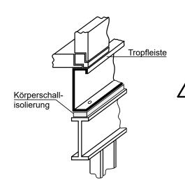
Die Isolierung des WOLF-Grundrahmens und seine Einbindung in die Dachabdichtung muss bauseits erfolgen.
