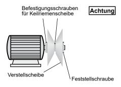
Keilriemenscheiben und Klemmschrauben der Spannbuchsen auf festen Sitz prüfen. Verstell-Keilscheiben werden vor Geräteauslieferung nicht eingestellt, sondern müssen bei Inbetriebnahme des Klimageräts vor Ort entsprechend justiert werden. Sie ermöglichen eine Drehzahländerung des Ventilators von 10%. Einstellung:
