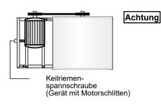
Die Keilriemen müssen erstmalig nach ca. einer Betriebsstunde nachgespannt werden. Danach ist eine Überprüfung in regelmäßigen Abständen abhängig von den Betriebsbedingungen erforderlich, höchstens jedoch in Abständen von 4 Monaten. Bei mehrrilligen Antrieben muss bei Keilriemenaustausch der gesamte Riemensatz erneuert werden!
