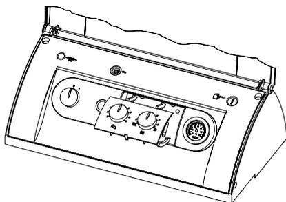
4. Clipser le plastron. Ensuite, enfoncer le commutateur rotatif pour l'eau chaude et celui pour le chauffage avec l'aiguille sur « 5 ». Finalement, tourner avec précaution les commutateurs rotatifs jusqu'en butée à gauche et à droite. S'il est impossible de tourner le commutateur rotatif jusqu'en butée à droite ou à gauche, sortir ce dernier et le tourner de 180°.
