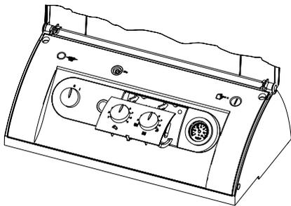
4. Klik de frontplaat vast. Steek daarna de draaiknop voor warm water en de draaiknop voor verwarming in met de wijzer op "5". Draai daarna de draaiknoppen voorzichtig tegen de linker en rechter aanslag. Als de draaiknop niet tot tegen de linker en rechter aanslag kan worden gedraaid, moet de draaiknop worden afgetrokken en 180° worden gedraaid.
