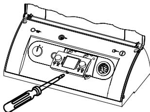
2. Retirer le module de commande BM de la régulation de chaudière.
