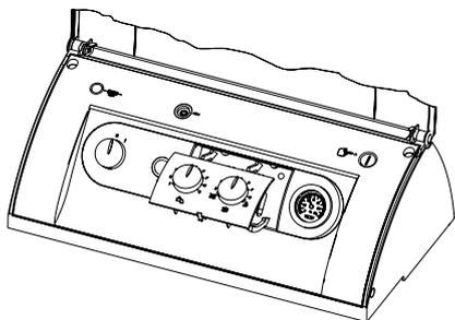
4. Inserire il pannello frontale con le clips. Successivamente inserire la manopola per acqua calda e quella per il riscaldamento con l'indice posizionato su „5“. Dopodiché girare le manopole con cura fino all'arresto destro e sinistro. Se non è possibile girare la manopola sull'arresto destro e sinistro, la stessa manopola deve essere tolta e deve essere girata di 180°.
