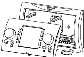
3. Inserire il modulo d'uso BM nello zoccolo a muro utilizzando le clips.
