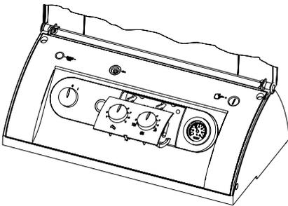
4. Frontblende einclippen. Danach den Drehknopf für Warmwasser und den Drehknopf für Heizung mit Zeiger auf "5" einstecken. Anschließend die Drehknöpfe vorsichtig auf Links- und Rechtsanschlag drehen. Lässt sich der Drehknopf nicht auf Rechts- und Linksanschlag drehen, muss der Drehknopf abgezogen und um 180° gedreht werden.
