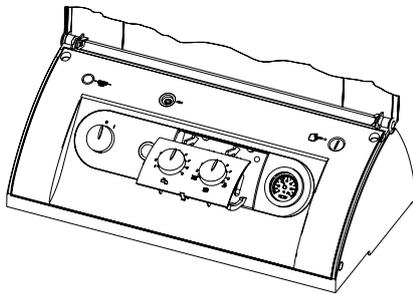
4. Frontpanelet klippes fast. Herefter indsættes drejeknappen til varmt vand samt drejeknappen til opvarmning med viseren stående på 5. Dernæst drejer man forsigtigt knapperne helt til venstre og helt til højre. Er det ikke muligt at dreje en knap helt til højre eller helt til venstre, skal den pågældende knap tages ud og drejes 180°.
