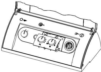
4. Encajar la placa frontal con los clips. A continuación, introducir los mandos de a.c.s. y de calefacción con las marcas señalando la posición „5“. Acto seguido, girar los mandos con precaución hasta el tope izquierdo y derecho. Si un mando no se deja girar hasta el tope derecho e izquierdo, hay que sacarlo y girarlo 180°.
