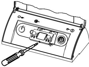
2. Вытащить модуль ВМ из панели управления котловой автоматики.
