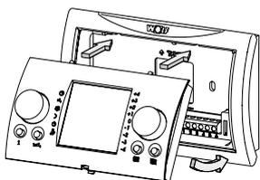
3. Clipser le module de commande BM dans le socle mural.
