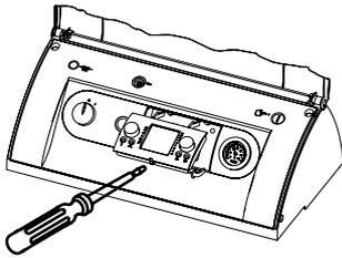
2. Verwijder de bedieningsmodule BM uit de ketelregeling.
