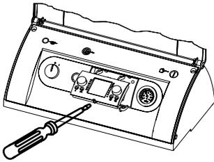
2. Bedienmodul BM aus der Kesselregelung entfernen.
