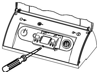
2. Estrarre il modulo d'uso BM dalla regolazione caldaia.
