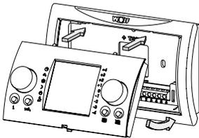
3. Bedienmodul BM in den Wandsockel einclippen.
