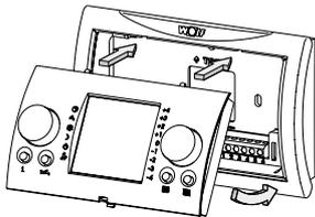
3. Klik de bedieningsmodule BM in de wandsokkel.
